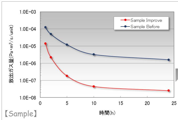
単にサンプルをチャンバーに入れて真空排気しその到達真空度をみるといったものではなくサンプルそのものから放出されるガスの量を算出します。これにより、実際に使用される対象物の数量や表面積、使用されるチャンバーの容量排気能力などを考慮し、所望の到達真空度や到達時間が達成出来るか？を推測する目安となります。
